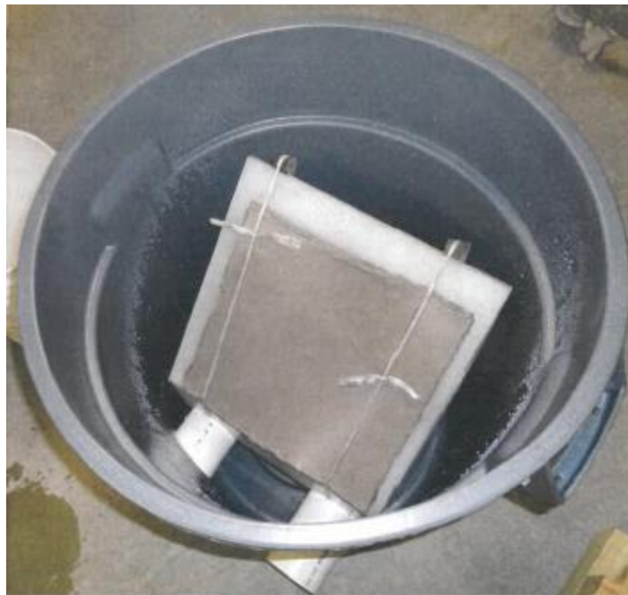
1. ábra A lejtős felületre rögzített, szélein szigetelt CC a zárt tartályban
